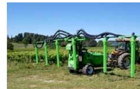
Figuur 17: Meerrijige spuittoestellen, a) met spuitdoppen
