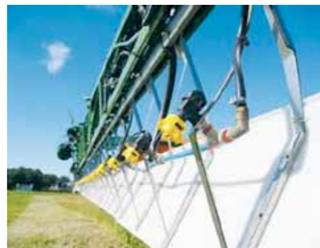
Figuur 20: Een sleepdoek zorgt voor een betere indringing door het openen van het gewas.
