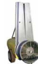
Figuur 7: Dwarsstroomspuittoestellen met luchtgeleiders
