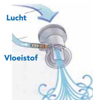
Figuur 18: Pneumatische vernevelaar
