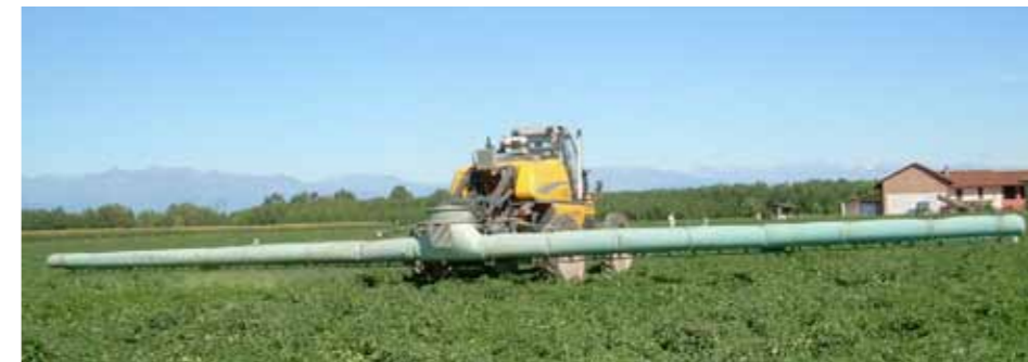
Figuur 28: Volleveldspuit met luchtondersteuning
